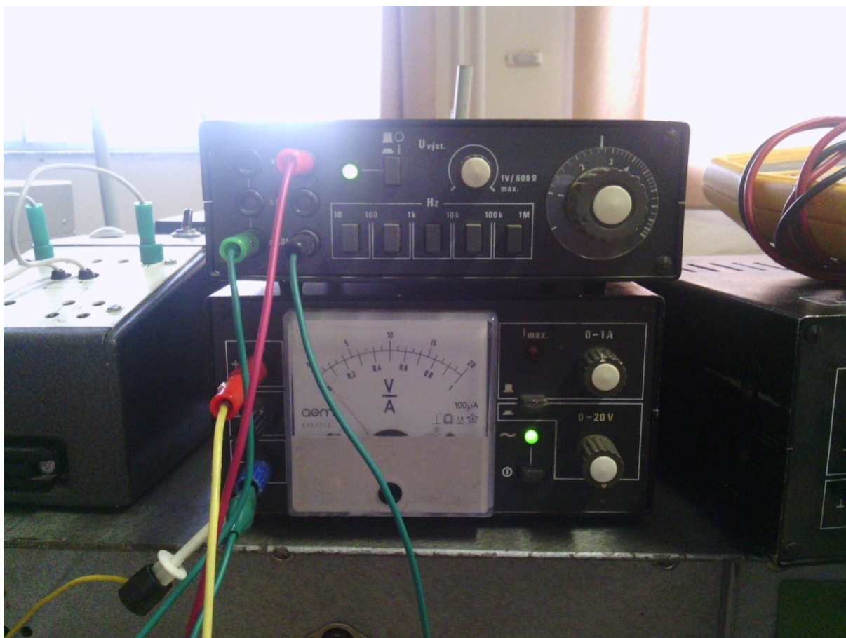
Generátor střídavého napětí s regulací výstupní frekvence
